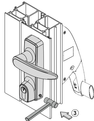
Sostituzione cilindro definitivo - Removal of final cylinder - Reemplacment du cylinder définitif - Reemplazo bombín definitivo - Demontieren des endgültigen Zylinders - Замена постоянного цилиндра - Demontaż wkładki docelowej
